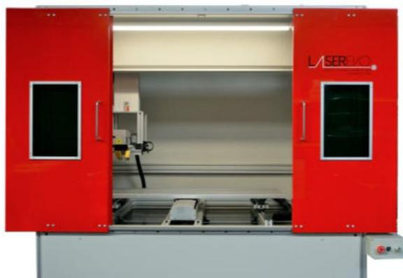
Sistema Gantry con assi motorizzati X Y Z, programmabili, gestiti direttamente da software
